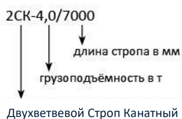
Рис. 2.23. Маркировка стропов и марочная бирка стропа
