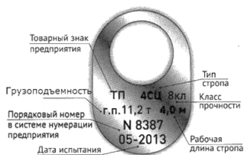
Рис. 2.23. Маркировка стропов и марочная бирка стропа
